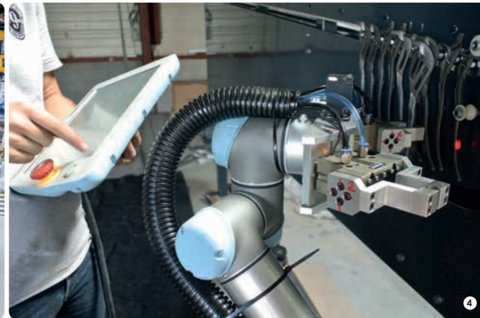
1 Cellules robotisées : intégration, conception et fabrication ligne d'assemblage avec cellules robotisées 2 Manipulateur : conception, réalisation et intégration 3 Machine spéciale, banc d'essais : machine d'assemblage de pommeau avec contrôle par camera 4 Cobotique : Intégration d'un URS pour automatiser le chargement et le déchargement d'une machine de trempe par induction 5 Machine spéciale : poinçonnage bouclier avant/arrière 6 Manutention : ligne d'assemblage demi-train 7 Retrofit : rénovation machine de découpe 8 Manutention : ligne d'assemblage demi-train 9 Cellules robotisées multi procédés
